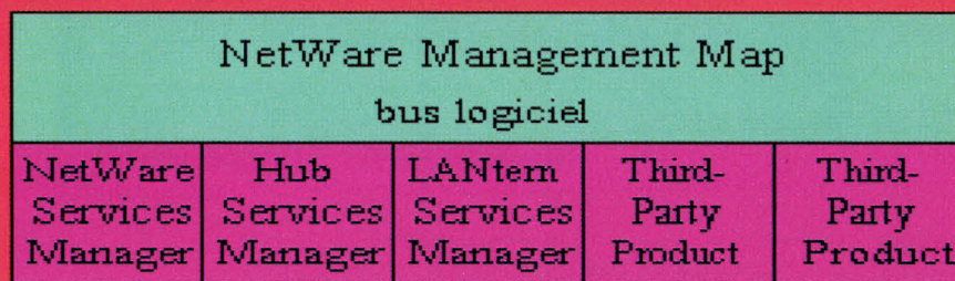
Figure - NetWare Management Map représente la couche principale de NMS sur laquelle viennent se greffer diverses applications.
