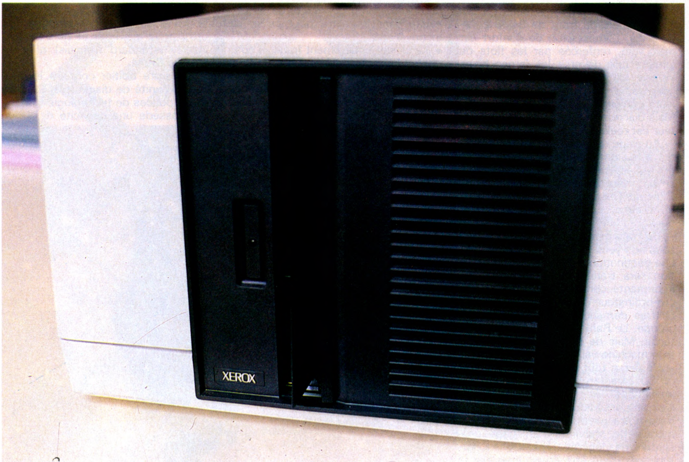
Le boîtier principal contient une unité de disquettes 8 pouces de 980 K octets et un disque dur de technologie Winchester 8 pouces également, de 10 millions de caractères.
