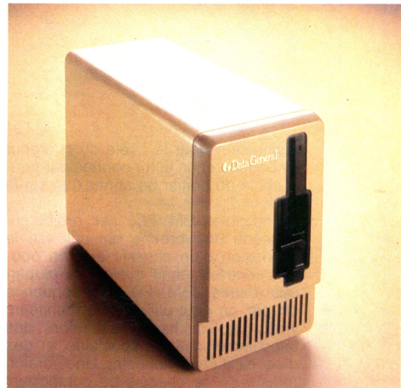
A gauche, le boîtier d'alimentation pour brancher le DG One sur le secteur. Et le chargeur de batterie. En bas, les deux lecteurs de disquette 3 pouces et demi incorporés dans le boîtier standard du DG One. A droite, le lecteur de disquettes externe 5 pouces un quart (8 050 F HT).
