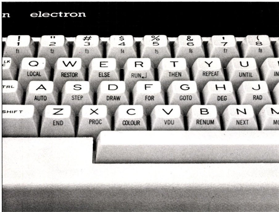
Le clavier mécanique de l'Électron est un de ses principaux atouts: les touches de gomme du Spectrum, en revanche, interdisent bon nombre d'applications sérieuses. Sur la face avant des touches de l'Électron, on distingue une série de mots Basic, qui ne constituent qu'une partie du vocabulaire particulièrement riche de la machine. Les mots Basic peuvent soit être tapés lettre par lettre, soit introduits par touche unique, après pression sur FUNC.
