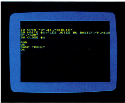
Exécution du programme d'écriture d'un enregistrement. La commande SAVE permet de sauvegarder le programme sur la disquette sous le nom "PGM1".
