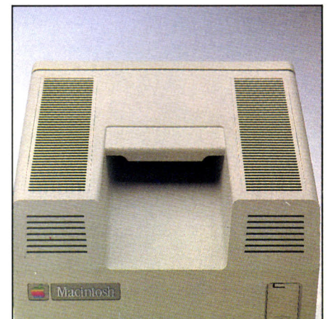
La poignée située au sommet de l'appareil ajoute au poids réduit (une dizaine de kilos) et à la housse de transport pour faciliter les déplacements.
