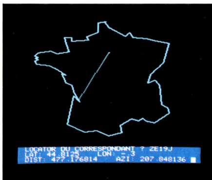
Le programme QTH locator visualise toute liaison réalisée en Europe du Nord. Ici Paris-Bordeaux.
