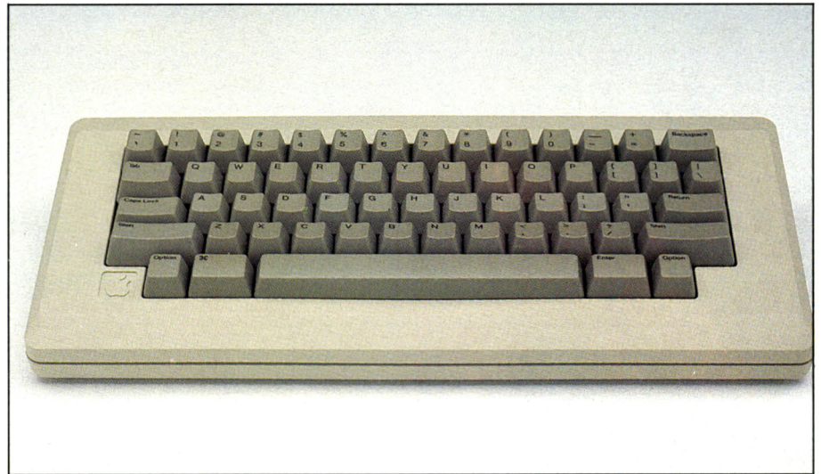
Le clavier, ici en QWERTY, sera francisé d'ici la mise en vente du Macintosh. Sa petite taille, aux dimensions réduites de l'unité centrale, a été obtenue en renonçant au bloc numérique et aux touches de curseur.
