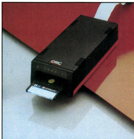
Relié par un câble en nappe à l'ordinateur, le lecteur de disquettes d'Oric possède une alimentation séparée très encombrante.
