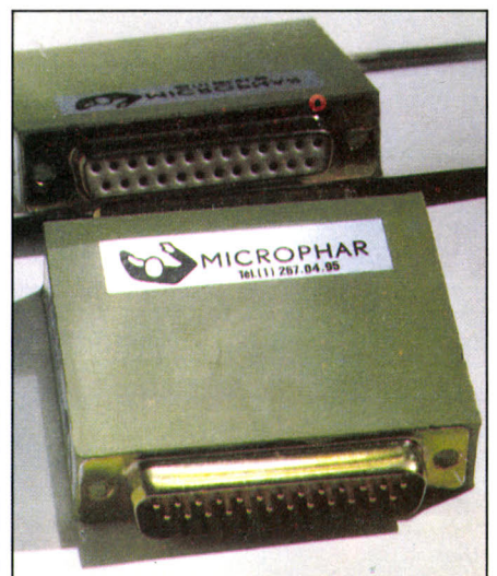
Les grands moyens : un "bouchon" électronique vendu avec le logiciel, branché sur l'une des sorties de l'ordinateur. Sans bouchon, le programme ne fonctionne pas.
