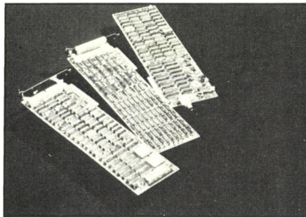
Les trois cartes qui transforment le PC XT en PC XT/370 : il sera très difficile de les copier.
