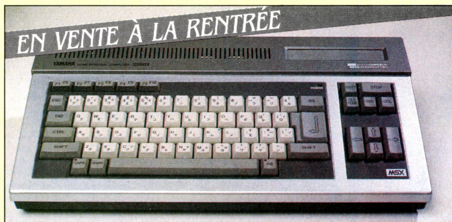
YAMAHA YIS 503 : Sans doute le plus original des ordinateurs MSX qui seront disponibles à la rentrée. Pour un supplément de 2 000 F environ, un synthétiseur relié à un clavier pourra en faire un véritable instrument de musique, comparable aux orgues électroniques de Yamaha. Un lecteur spécial permettra aux jeunes enfants, en faisant défiler une carte magnétique, d'écouter la chanson de leur choix ou de charger des jeux graphiques. Dans l'un de ceux-ci, l'enfant doit assembler un puzzle en déplaçant des pièces avec les touches de curseur. C'est Yamaha lui-même qui réalisera la documentation en français. Sortie Péritel mémoire vive de 32 Ko, un seul connecteur de cartouches.
