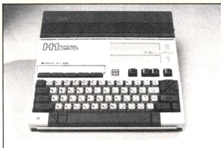
HITACHI MB H1 : Montré au Spécial SICOB en mai à Paris, cet ordinateur n'a encore fait l'objet d'aucun accord d'importation. Assembleur, logiciels musical et graphique incorporés. Alimentation détachable pour le transport, mémoire vive de 32 Ko, deux connecteurs de cartouches.
