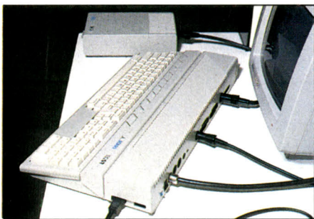
L'arrière du ST 130. Quelques coupes dans le boîtier n'ont pas encore reçu leur prise. A l'arrière-plan, le lecteur de disquettes 3 1/2 pouces.
