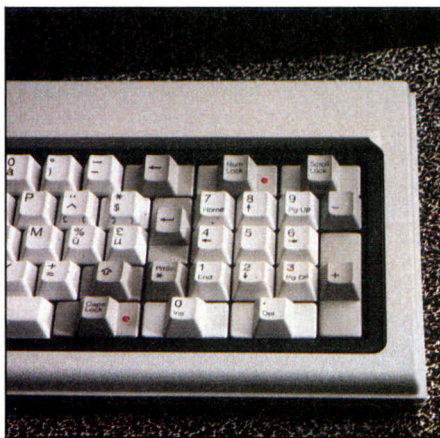
Les touches CAPS LOCK et NUM LOCK signalent leur position par un petit voyant.
