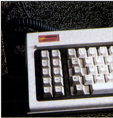
Le clavier, compatible avec celui de l'IBM PC est d'un toucher très doux, à clic sonore ajustable.
