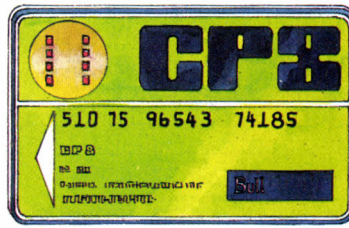
La carte CP8 de Bull. Seulement 6 contacts sur 8 sont effectivement employés.
