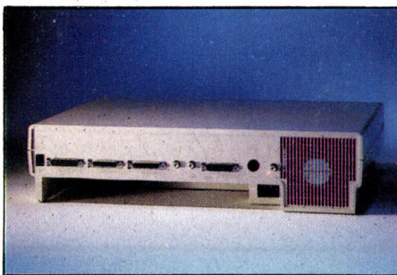
À l'arrière, un alignement impressionnant de connecteurs. À droite, le ventilateur de l'alimentation électrique qui fonctionne silencieusement.
