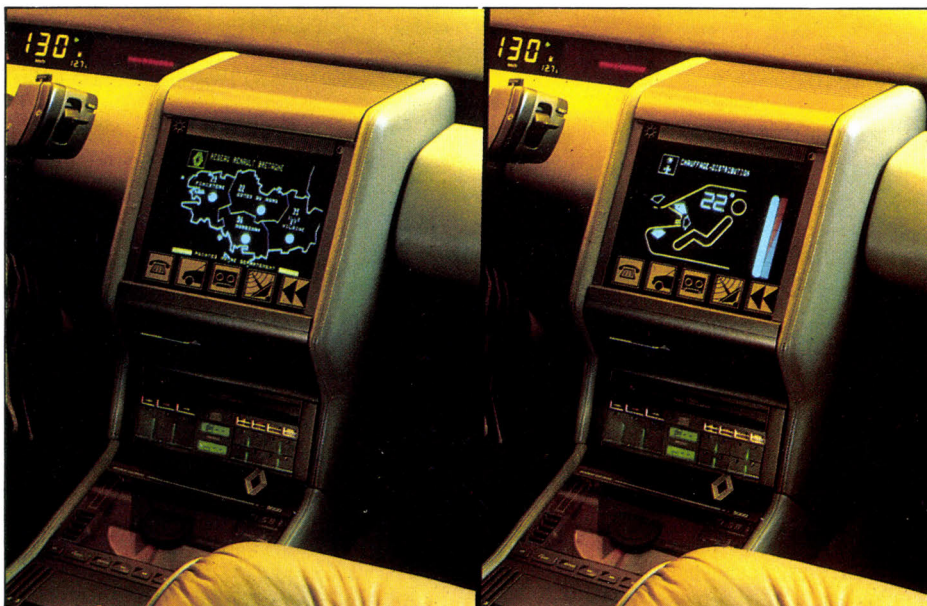
Le système Dialog-Atlas de Renault : aide à la circulation, mais également contrôle total sur le fonctionnement du véhicule (consommation moyenne, usure des freins, etc.).
