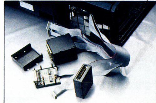
3. Installation des boîtiers de connexion aux modems
