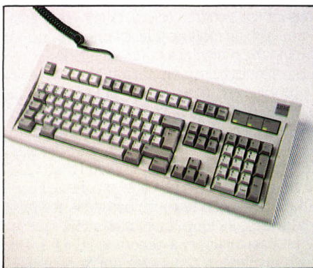
Le nouveau clavier, avec ses 102 touches, tient compte des critiques faites à l'ancien.
