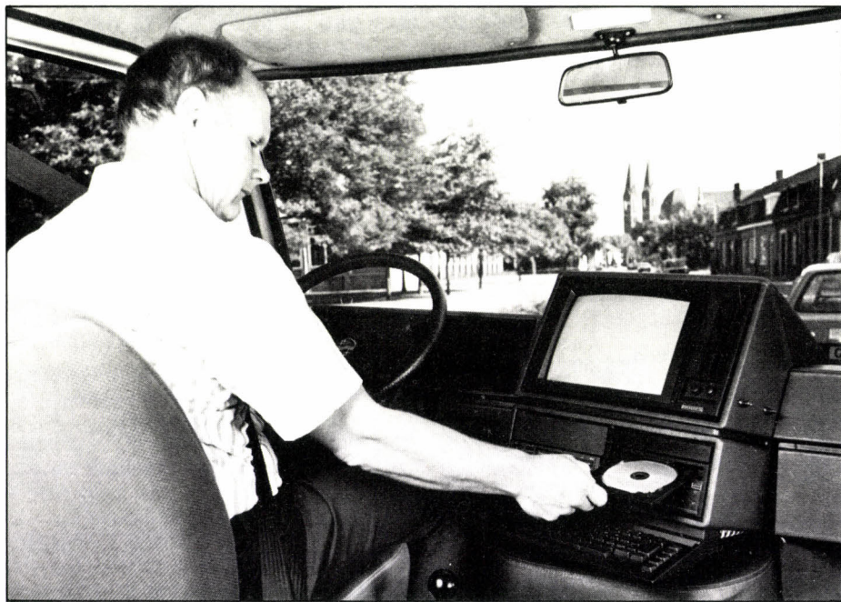
Le système Carin de Philips, une synthèse de tous les systèmes existants : ordinateur de bord avec lecteur de CD-ROM, boussole électronique, réseau de capteurs et... audio-radio !
