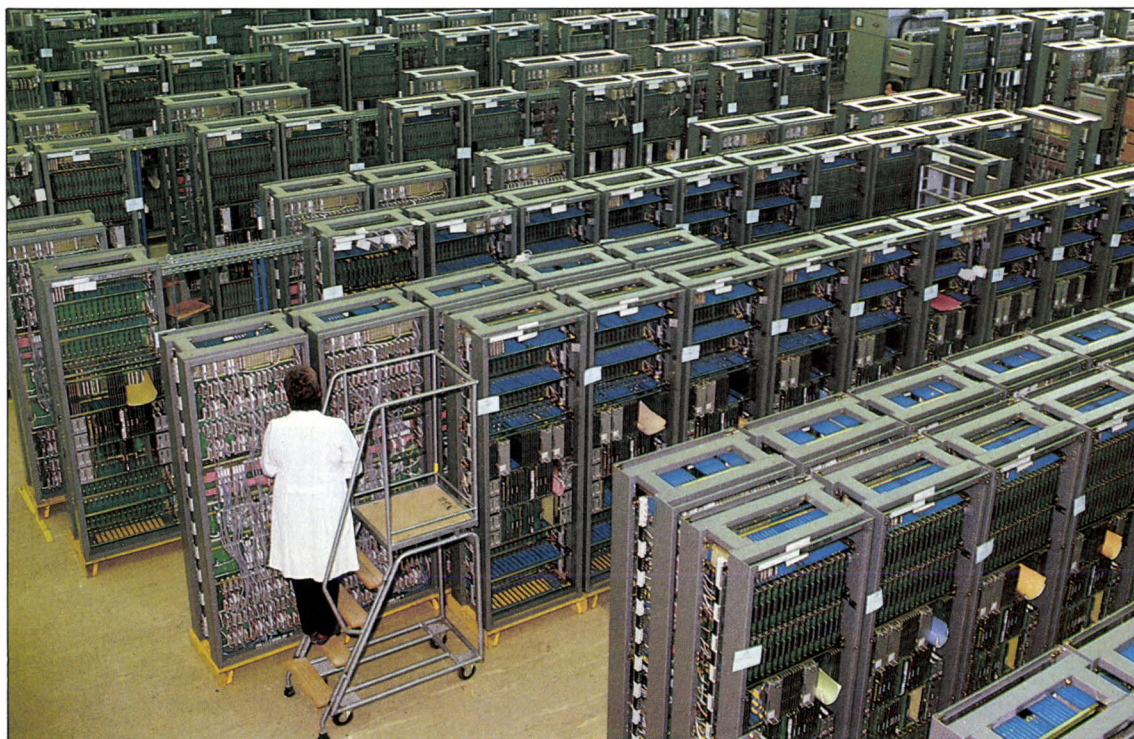
Les commutateurs temporels, comme cet E 10 d'Alcatel, sont d'énormes ordinateurs. Ils font transiter les communications et sont à la base du RNIS.
