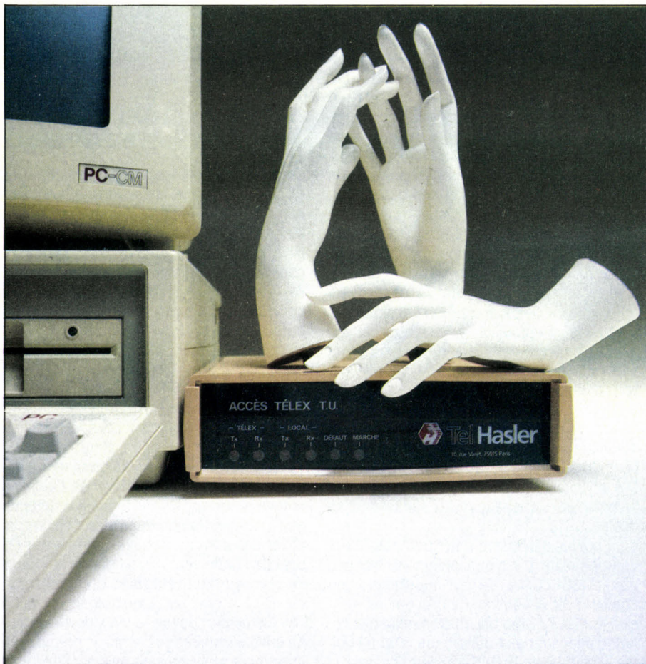
Ce boîtier transforme un micro-ordinateur en terminal télétext.
