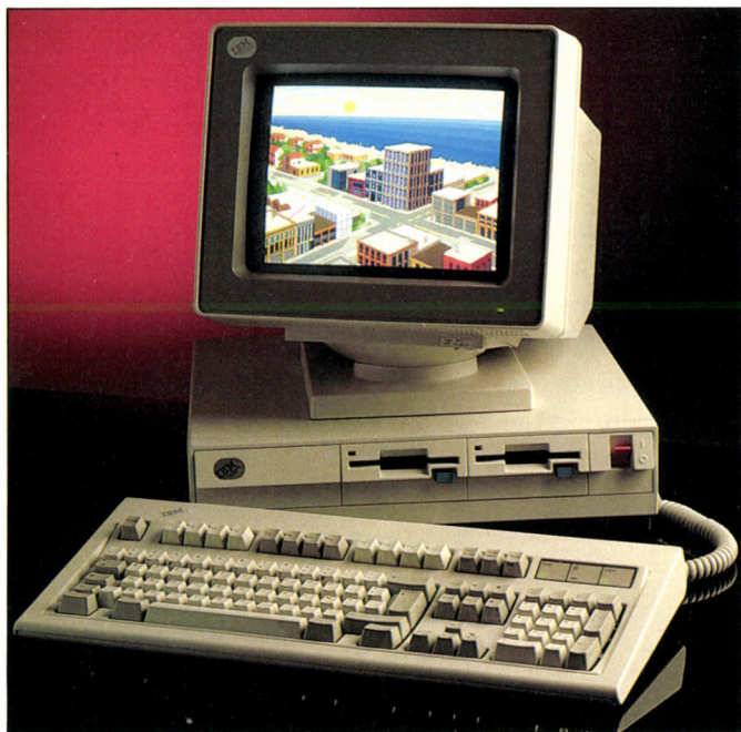
A gauche, l'IBM 8530 avec ses deux lecteurs de disquettes 3 pouces 1/2 et un écran couleur orientable. A droite, l'IBM 8550 avec un lecteur de disquettes et un disque dur unique de 20 Mo.
