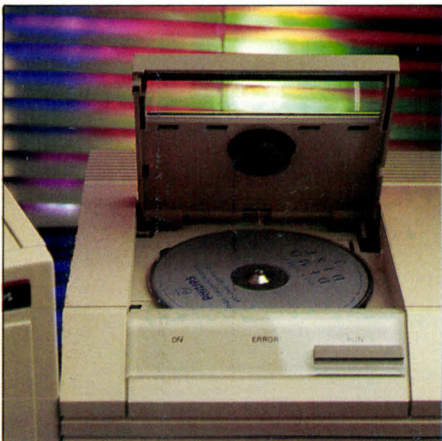
Le CD-ROM se présente comme un disque compact musical, mais on l'insère dans un lecteur spécial, relié au compatible IBM PC.
