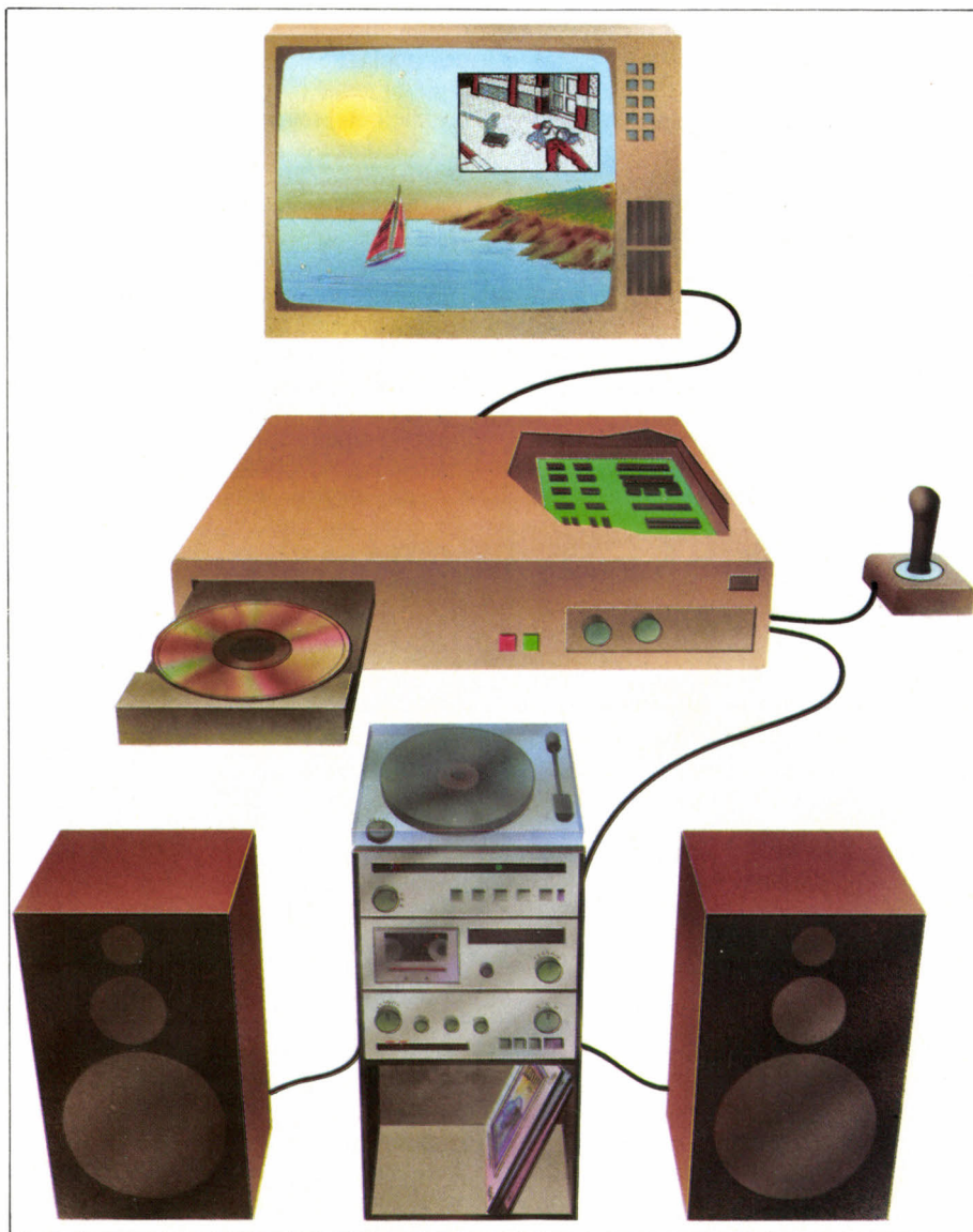
Le CD-I semble tenir à la fois du lecteur de vidéodisques, du lecteur de disques laser et de l'ordinateur. En fait, son boîtier discret – qui remplacera la platine laser – sera relié d'un côté à la prise PériTel d'un téléviseur couleur, et de l'autre, au connecteur auxiliaire d'une chaîne hi-fi.
