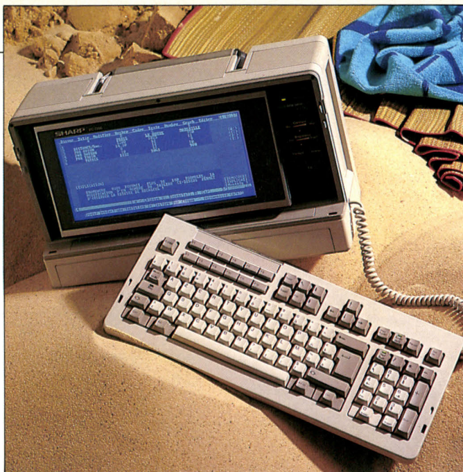
L'écran du PC 7200 est du type cristaux liquides éclairé par l'arrière. Le contraste obtenu est saisissant.
