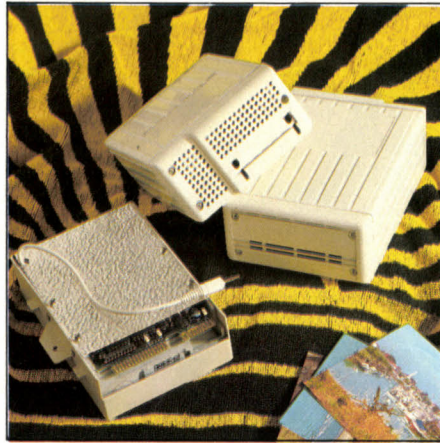
Les disques durs amovibles. Celui du VPC3/286 (en bas à gauche) nécessite un cordon d'alimentation, alors que ceux du PAC 286 sont alimentés via leurs connecteurs.
