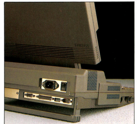
A l'arrière du Toshiba T 5100, un connecteur pour lecteur de disquettes 5 pouces 1/4.
