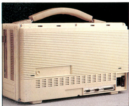
A l'arrière du Compaq Portable 386, un connecteur pour boîtier d'extension.
