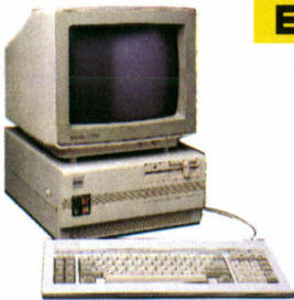
RS 232C et sortie parallèle — Carte contrôleur disques souples et disque dur — Disque dur 20 Mo — Lecteur de disquettes 1,2 Mo — Clavier AZERTY 102 touches — Alimentation 230 W — MS-DOS 3.1 avec manuel — Une disquette diagnostic + 1 manuel d'utilisation. Garantie 1 an pièces et main d'œuvre.
