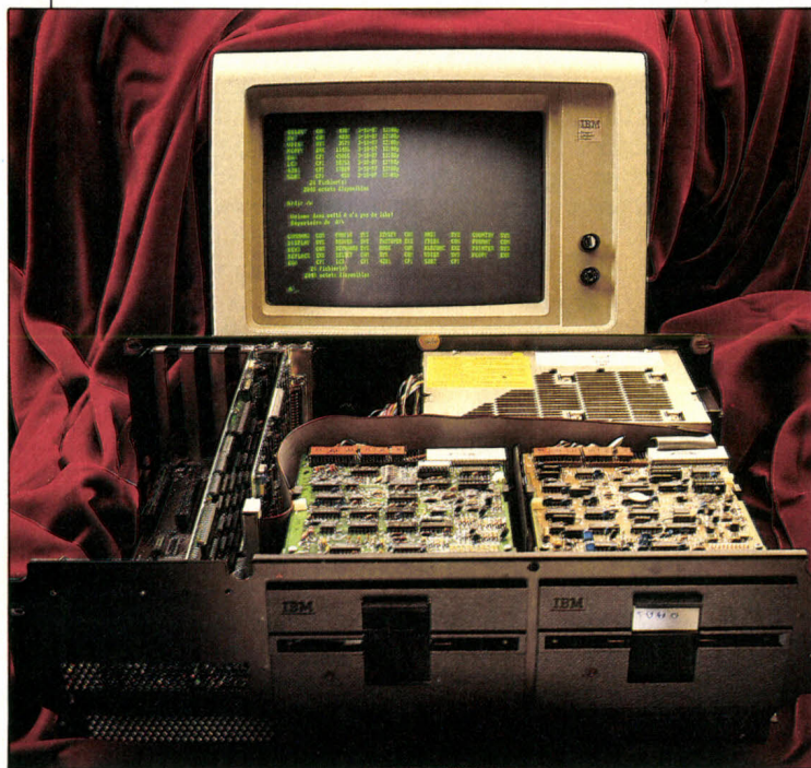
Dans sa configuration de départ, le PCG n'a reçu qu'une amélioration : une carte graphique Hercules, monochrome. A l'arrivée, une carte accélératrice (Quad 386 XT), une carte EGA (EVA 512), une extension mémoire (Above Board PC), une carte à disque dur (Filecard 30).
