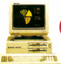
Microprocesseur 8088-2 (4,77/8 MHz) — 640 Ko de RAM — 2 lecteurs de disquettes 360 Ko — Carte vidéo multimode : monochrome (MDA/Hercules) et couleur (CGA) — Sorties série et parallèle — Clavier AZERTY 84 touches — 7 slots d'extension — Alimentation 135 W — MS-DOS 3.2 et GW-BASIC — Manuel en français — Garantie 1 an pièces et main d'œuvre.
