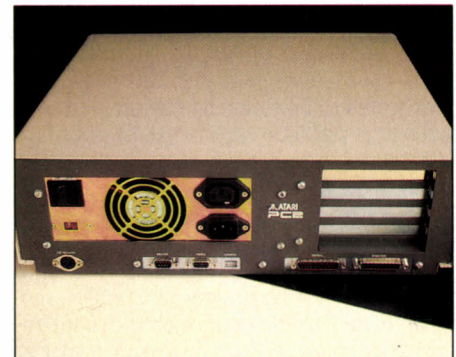
A l'arrière du PC 2, on note la disposition horizontale des cartes d'extension.
