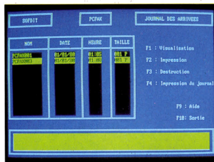
Le journal des arrivées de la PC Fax indique le nom du document, la date et l'heure de son arrivée, et sa taille.
