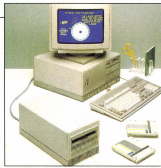
Le disque WORM et ses supports enregistrables une fois.
