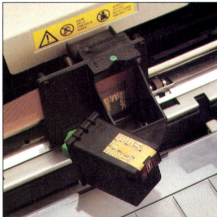
La cartouche d'encre jetable contient aussi les buses qui produisent le jet d'encre. On distingue les nombreux contacts électriques.
