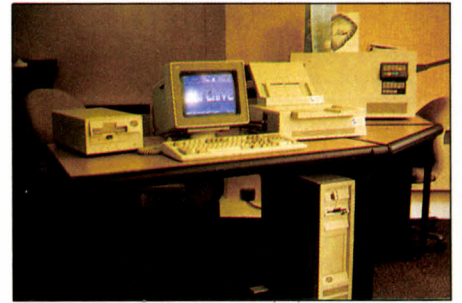
Le système Jarchive : disque optique et PS/2.
