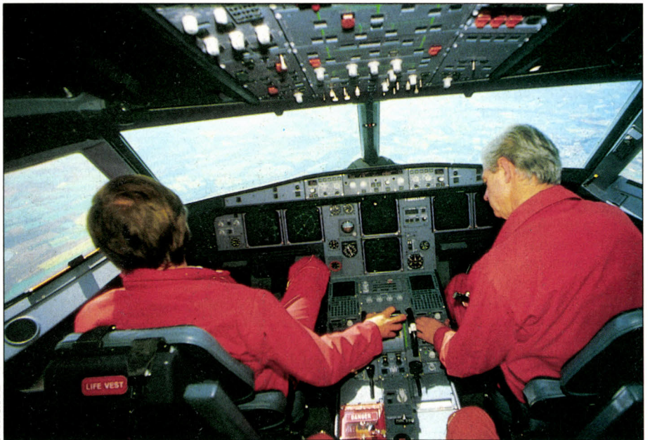
Airbus A 320 : le premier avion à posséder un système de commande entièrement informatisé.
