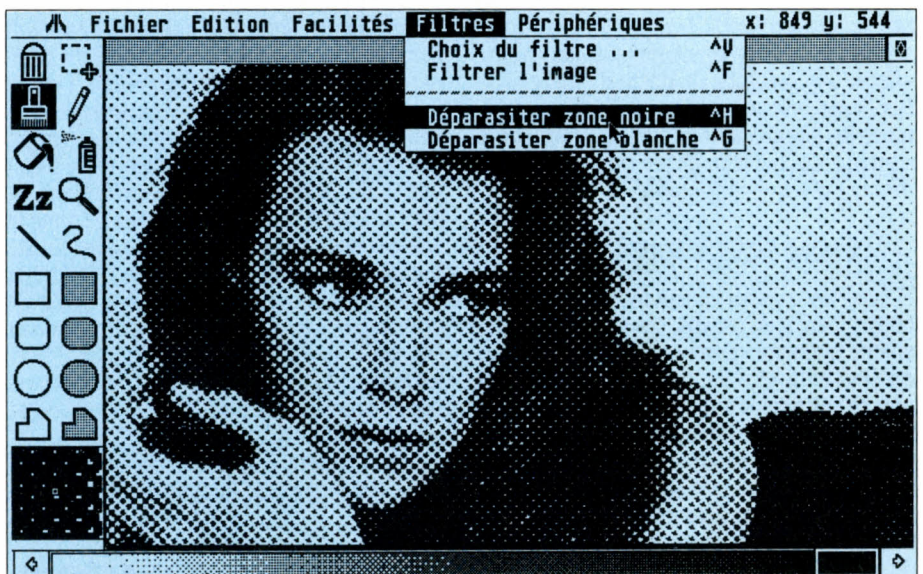
La déparasitage des zones noires élimine les points blancs isolés dans les zones sombres.
