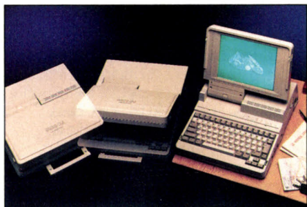
Sharp PC-5541 : écran à cristaux liquides de 640 x 480 points et 16 niveaux de gris.
