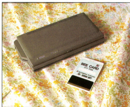
Le stockage des données se fait sur cartes électroniques de 55 x 85 mm !
