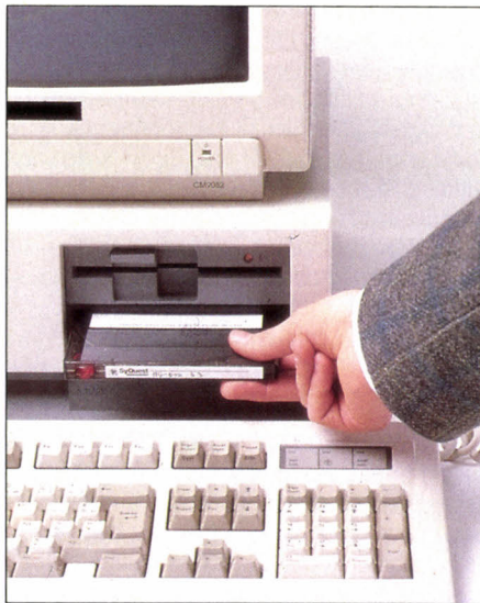
Son disque dur amovible est une cartouche Syquest de 44 Mo, au format 5 pouces 1/4.
