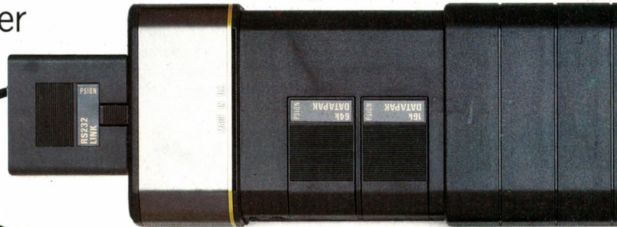
Un port de 16 broches permet de le connecter à d'autres périphériques.
