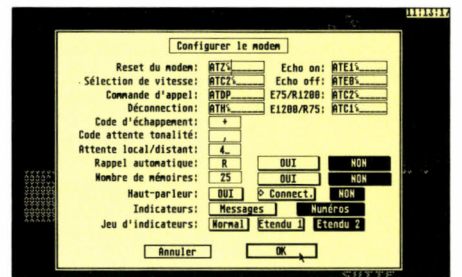
Pour l'un et l'autre logiciels, les vitesses de transmission peuvent atteindre jusqu'à 19 200 bits/seconde.
