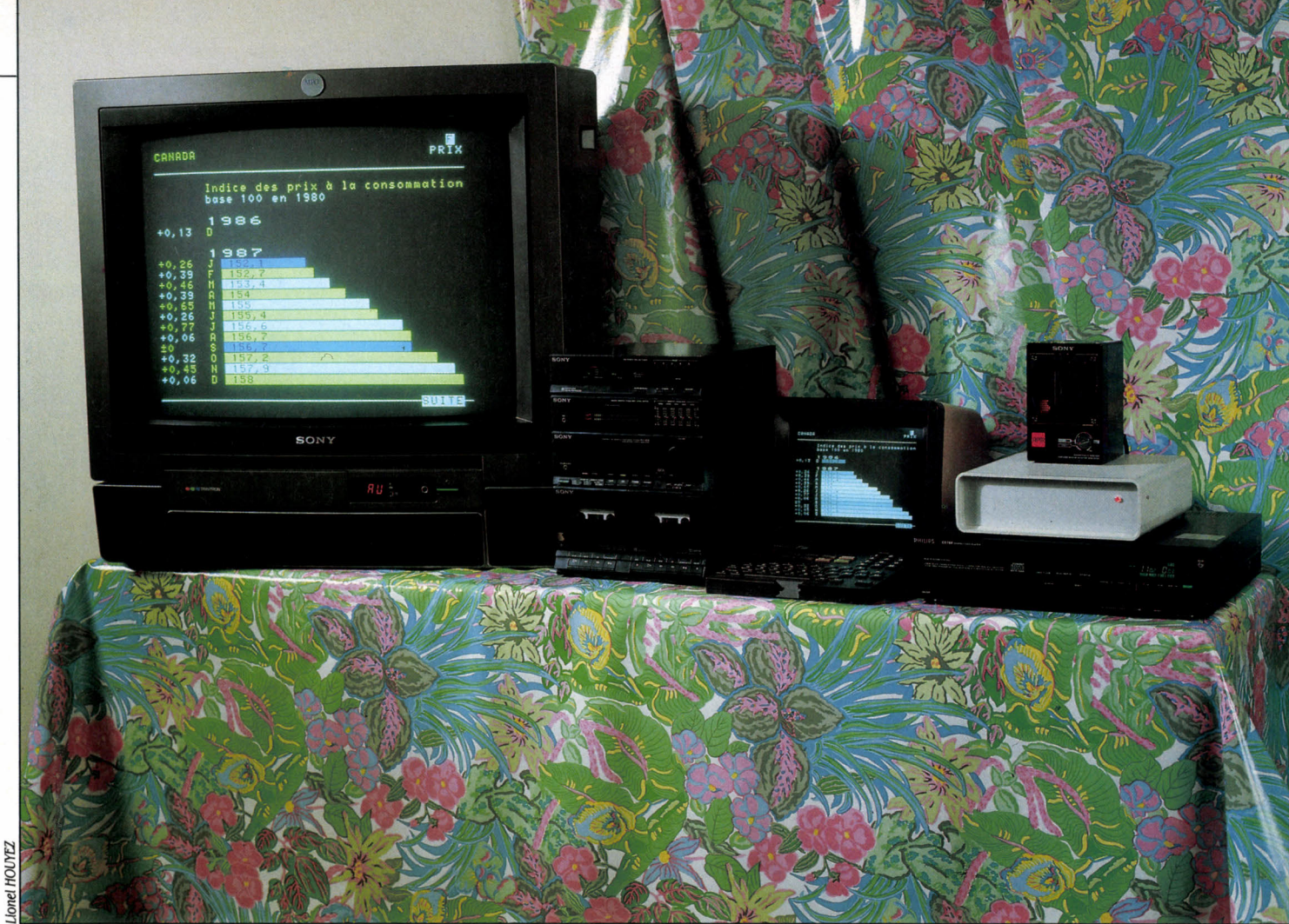
La chaîne CD-TEL au grand complet : écran de télévision, lecteur de disques compacts et ampli hi-fi, Minitel bi-standard en boîtier d'interface interactive avec télécommande.
