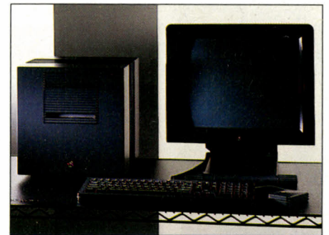
Le Next est un cube noir de 30 cm de côté. Au premier plan, l'écran de 17 pouces de diagonale.
