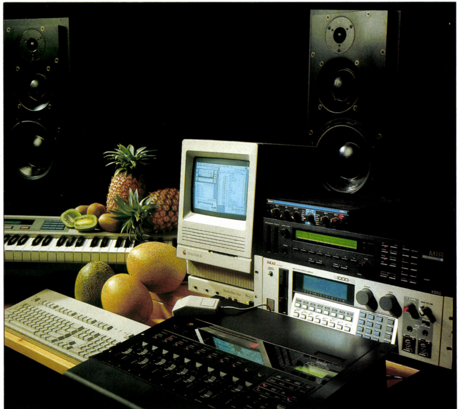
Un studio personnel professionnel : Macintosh SE/30 avec 4 Mo de mémoire vive et disque dur interne de 40 Mo, interface MIDI Studio Plus 2, logiciel Performer 2.41, clavier maître Akai MX76, expandeur Korg M1R, échantillonneur Akai S1000 HD, console DMP7, réverbération Lexicon LXP1. Total : environ 150 000 F.
