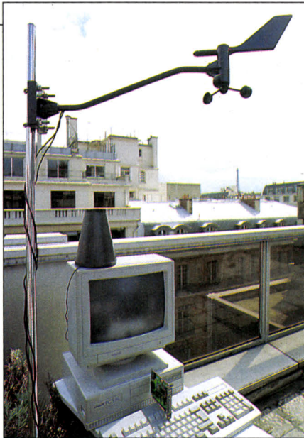
Autour de l'IBM PC, carte d'acquisition des données, anémomètre, girouette et pluviomètre.
