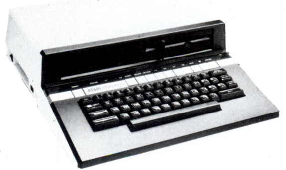
▶ Atari 1450 XLD : modem, synthétiseur de voix et lecteur de disquettes intégrés.
