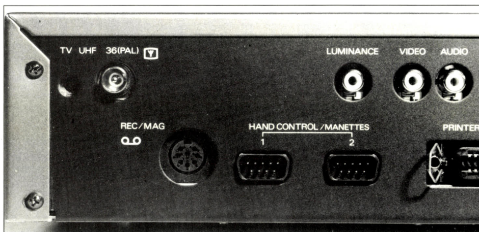
Le NMS 8250 propose de nombreux connecteurs en version de base. Le signal vidéo possède trois sorties : péritel RVB, UHF Pal sur canal 36 et signal pseudo-composite avec luminance séparée.
