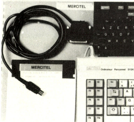
Un câble, un minitel et un logiciel: le minimum pour communiquer avec un PC.
