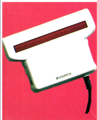
L'un des nombreux scanners à main, le ScanMan digitalise une image de 10 cm de large.
