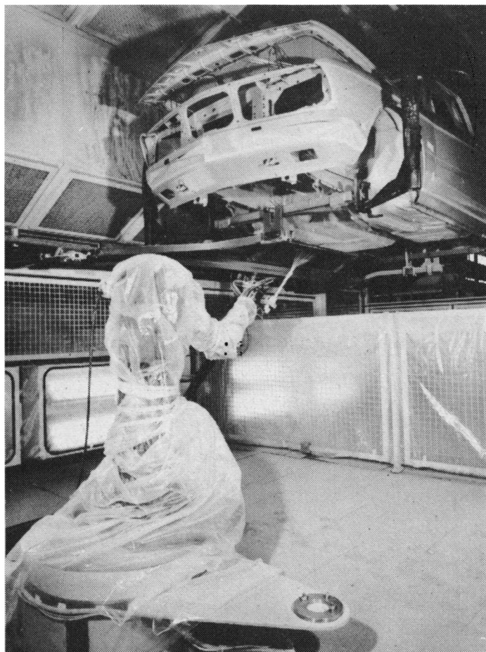
Das Bild zeigt einen Industrieroboter im BMW Werk 2 in Dingolfing beim Auftragen des Unterbodenschutzes. Der Roboter erfüllt dabei – je nach Modellreihe – verschiedene Programme.
