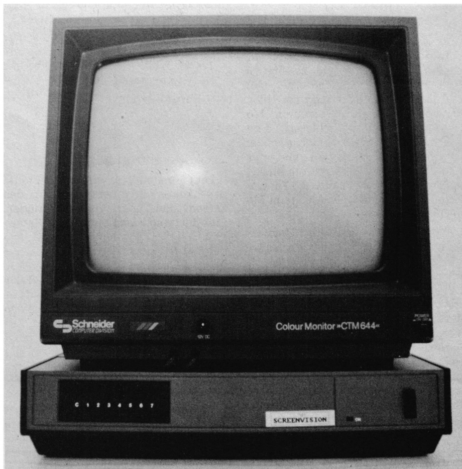
Nicht nur als Monitorständer geeignet. "Screenvision" ergänzt den Monitor zum vollwertigen Fernsehgerät.
