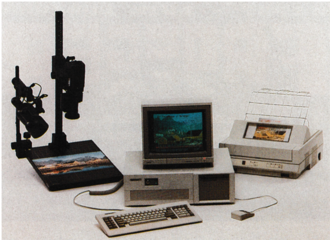
Ein komplette Editierstation: Videokamera auf Repröstander, AT im Industriestandard mit drei eingebauten Foto-Videotext-Karten, in dem die Bilder digitalisiert und verändert werden können und der Farbdrucker zum Ausdruck der bearbeiteten Seiten
