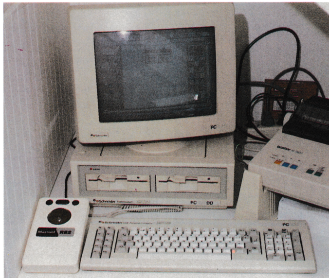
Wenn's der Maus zu eng wird, hilft der Trackball weiter. Die Bewegung der Kugel ersetzt das Herumfahren mit der Maus.
