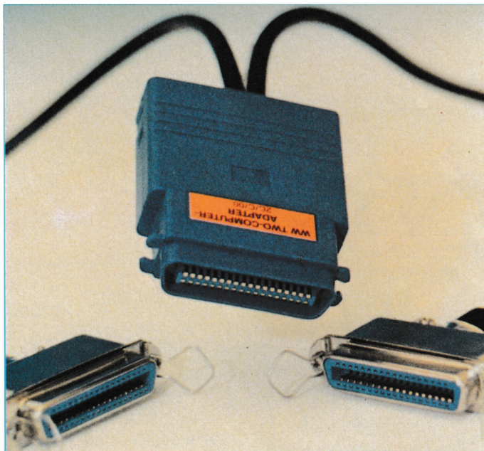
Ein Drucker für zwei Computer: Mit dem Multi Computer Adapter problemlos möglich
