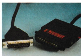
Ein Drucker für zwei Computer: Mit dem Multi Computer Adapter problemlos möglich
