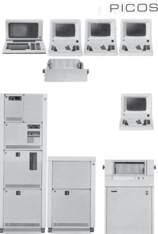
Systemkonfiguration der IBM Serie/1 für PICOS
