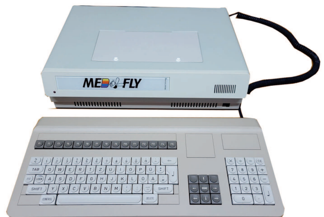
Der Medfly-Computer benutzt ein Basis-108 Motherboard
