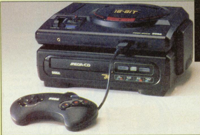
Der Mega-Drive mit CD-Laufwerk im Verbund
