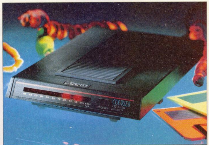
US Robotics vom Feinsten: Das Courier V32terbo quetscht Daten mit 19200 Bit/s durch die Leitungen
