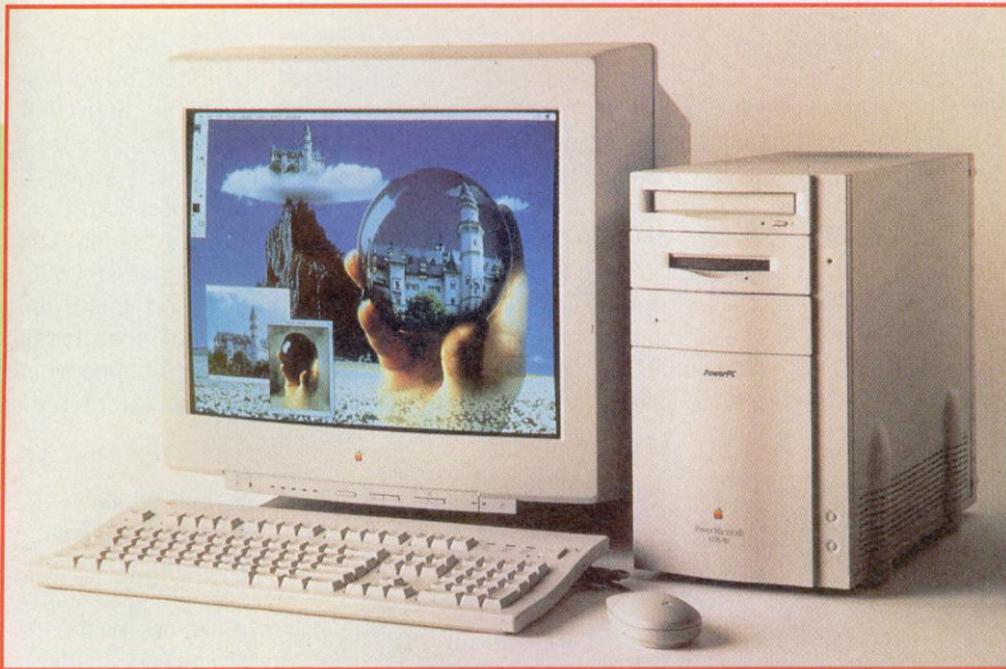
Das ist er in seiner ganzen Pracht: der Power-Macintosh 8100/80. Ausgestattet war er mit 16 MByte RAM, einer 500er Festplatte und einem Power-PC 601 mit 80 MHz Taktfrequenz.
