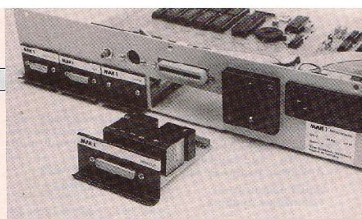
Bild 1. Eine Netzsteckdose für Schaltuhrbetrieb ist eingebaut
