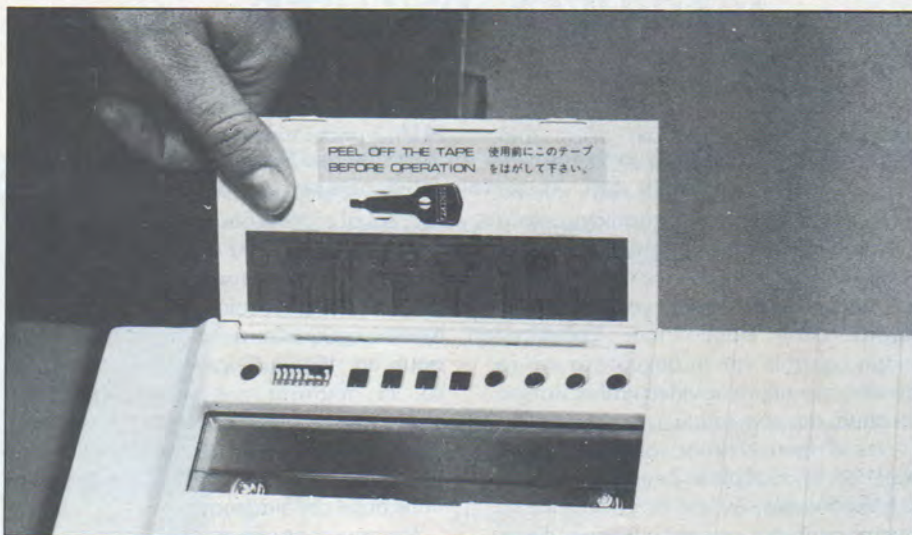
Ποτενσιόμετρα και διακόπτες δύο θέσεων ρυθμίζουν διάφορες παραμέτρους λειτουργίας.
