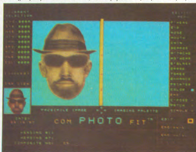
Μια οθόνη του συστήματος ComPhotoFit, εκτυπωμένη απ' ευθείας από τον PC σε φιλμ polaroid. Στο δεξί παράθυρο υπήρχε η εικόνα που δημιουργήθηκε από τις κάρτες χαρακτηριστικών που διάλεξε ο μάρτυρας. Στη συνέχεια μεταφέρθηκε στο αριστερό (όπου βρίσκεται τώρα) για μικροδιορθώσεις. Η μικρή εικόνα δείχνει μια απομακρυσμένη άποψη του πορτραίτου.
