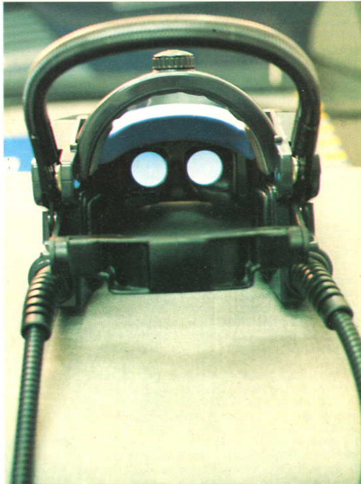
Il visore utilizza due monitor che forniscono un'immagine stereoscopica notevolmente nitida ed il suono stereo è di prima qualità.
