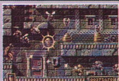
I tipacci sono grossi anche 32 x 32 pixel e ce ne possono essere fino a dieci contemporaneamente sullo schermo. Il personaggio principale è di 48 x 32 pixel con dieci fotogrammi per l'animazione del movimento e otto per le pose d'attacco.
