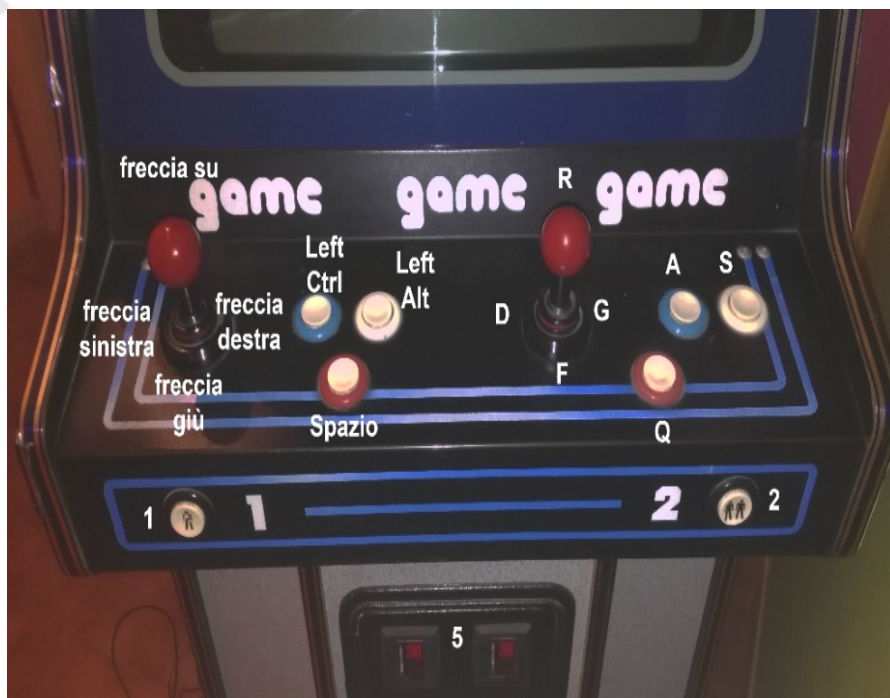
Fig.8 – Esempio di configurazione dei pulsanti del cabinato tramite software della JammASD.
