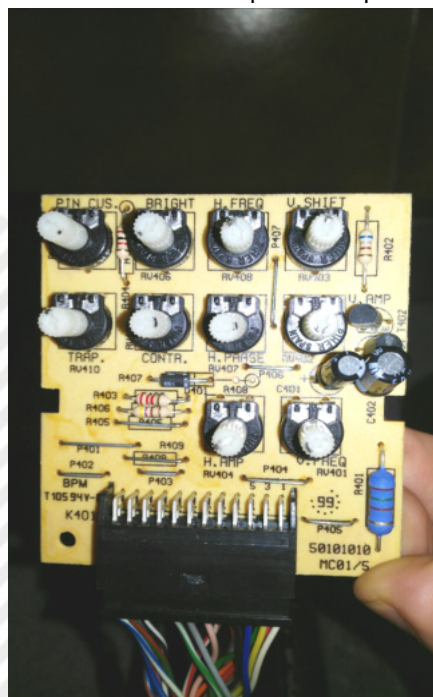
Fig.5 - Schedina esterna di controllo del CRT
