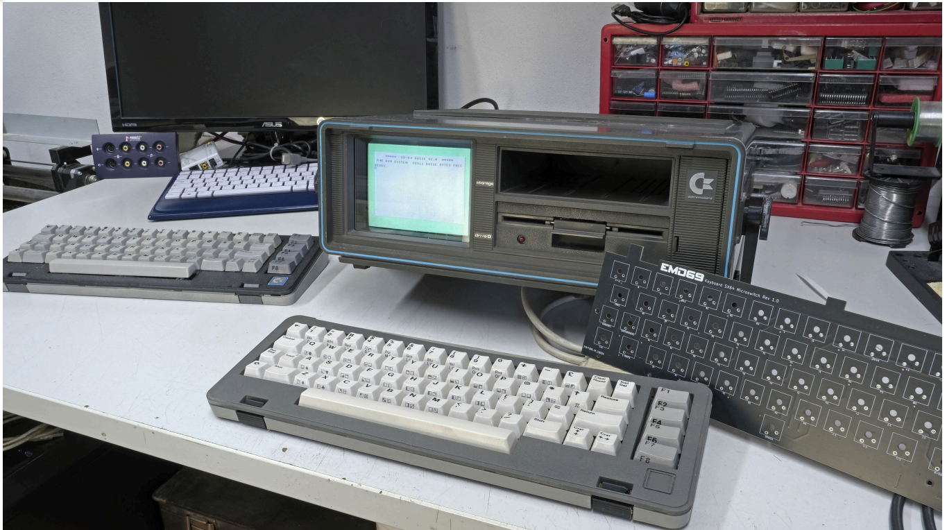
Tastiera e membrana KBSX64U in funzione su un SX-64
