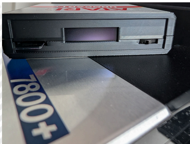
Slot per microSD, display OLED e selettore per la navigazione
