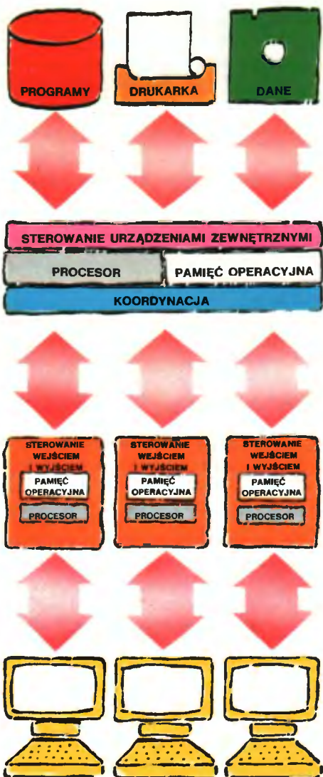
Rys. 2. W wielokomputerowym systemie z komputerem nadrzędnym (ang. master-slave system) jeden z mikrokomputerów – komputer nadrzędny (ang. master) obsługuje urządzenia zewnętrzne: drukarkę, ploter, pamięć masową (stacje dysków wymiennych i niewymiennych). Pozostałe mikrokomputery są jednak urządzeniami inteligentnymi – mają własne procesory i pamięci robocze. Przetwarzanie wykonują mikrokomputery podległe (ang. slave) – programy, potrzebne w danej chwili, są ściągane z komputera nadrzędnego.
