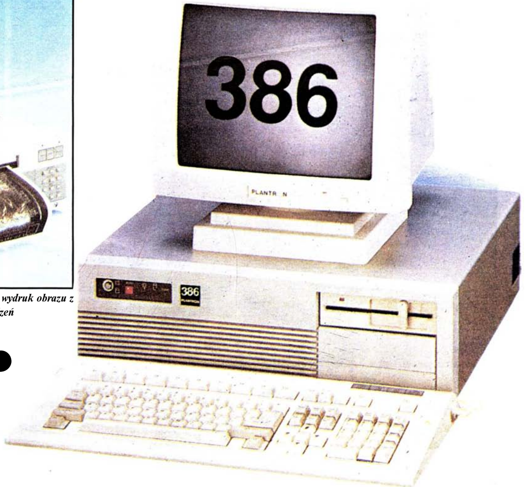
Komputer Plantron PT-386: procesor 80386 z zegarem 16 MHz system operacyjny MS-DOS 3.2
