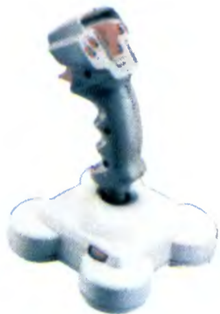
SV 201 Quickjoy M 5 Do IBM XT/AT (kompatybilnych) Współpracuje z Game-Card lub I/O Card 2 Fire 2 AutoFire 6 Mikrostryków Wybór AUTO PSC — Regulator XY Sygnalizacja Świetlna Fire ASC — Regulator szybkości AUTO
