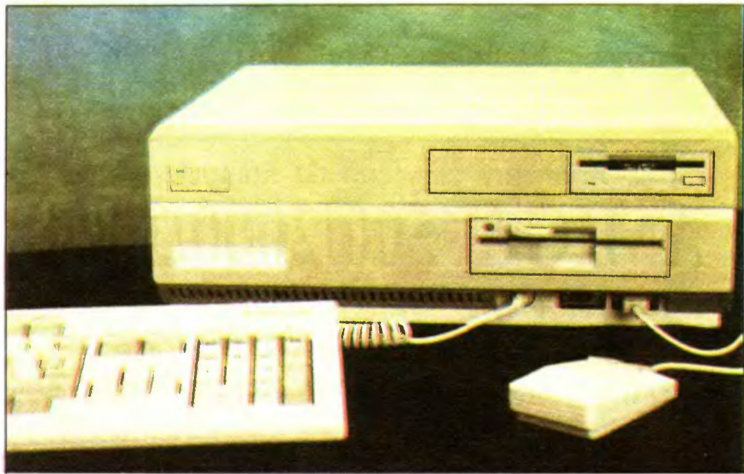
Amiga 2000 — widok ogólny. Zainstalowana stacja 5.25" pochodzi z zestawu karty ATbridgeboard.
