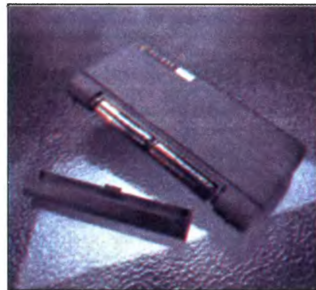
Fot. 2. Podstawowe zasilanie Psion-a stanowią dwie baterie typu R6 zapewniające 80 godzin ciągłej pracy.
