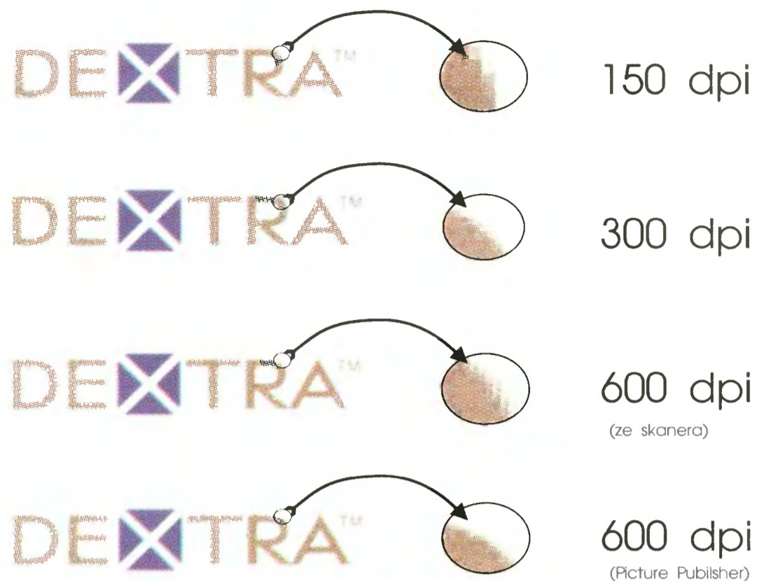
Rys.1 Trzy pierwsze rysunki pochodzą bezpośrednio ze skanera i były skanowane z podaną z boku rozdzielczością. Czwarty powstał po podbiciu programem Picture Publisher rozdzielczości rysunku 300 dpi do 600 dpi. Na powiększeniu widać, jak różnią się między sobą szczegóły.
