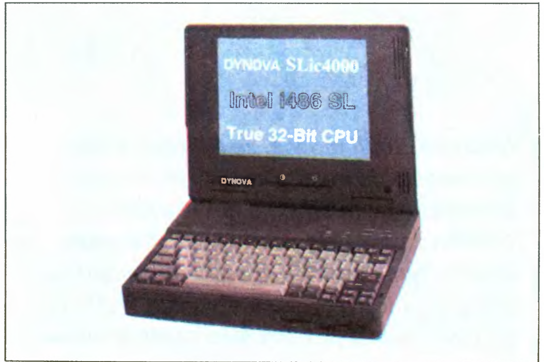
Notebook Dynova SLic 4000 jest typowym reprezentantem najnowszych trendów. Za 2300 USD otrzymujemy komputer z procesorem 486 SLC/33 MHz, 4 MB RAM, 130 MB dyskiem twardym, wbudowanym modemem, i kartą VGA z 512 KB pamięci. Całość waży 2,5 kg
